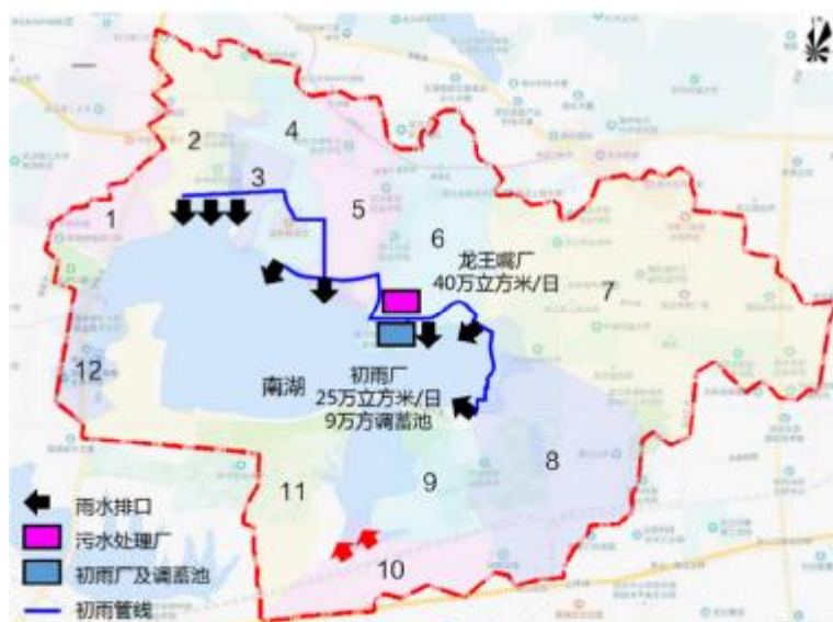
图 2-13 龙王嘴初雨厂扩建及初雨截流管道方案
