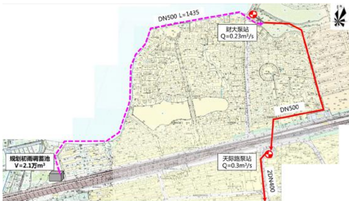
图 4-8 调蓄池出水管道路由示意图
